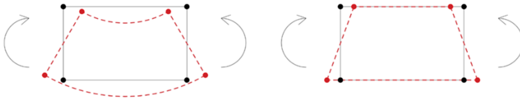
Porównanie odkształcenia rzeczywistego (po lewej) z odkształceniem elementu Q4 (po prawej)
